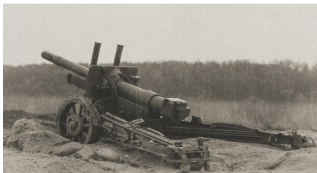
Рис. 1 – Орудие калибра 152 мм, образца 1937 г. (МЛ – 20 индекс 52-Г-544А – гаубица-пушка)
